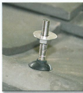
▲支柱ボルト、レベルナット
