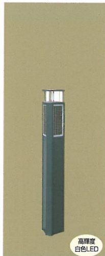
ATR-03CBD ▶18P ソーラーアプローチライト オールラウンドタイプ 0.3W/12時間点灯 外形寸法：最大径195×高さ1,100mm 光源：高輝度白色LED 0.3W 消費電力量：7.5W 標準価格：185,000円
