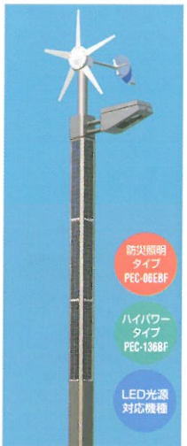
HFE-098BF ▶14P ハイブリッド照明灯 9W/8時間点灯 外形寸法：□202×高さ5,295mm 光源：FPL9EX-N インバータ点灯 消費電力量：144W 風力発電：50W 標準価格：1,539,000円
